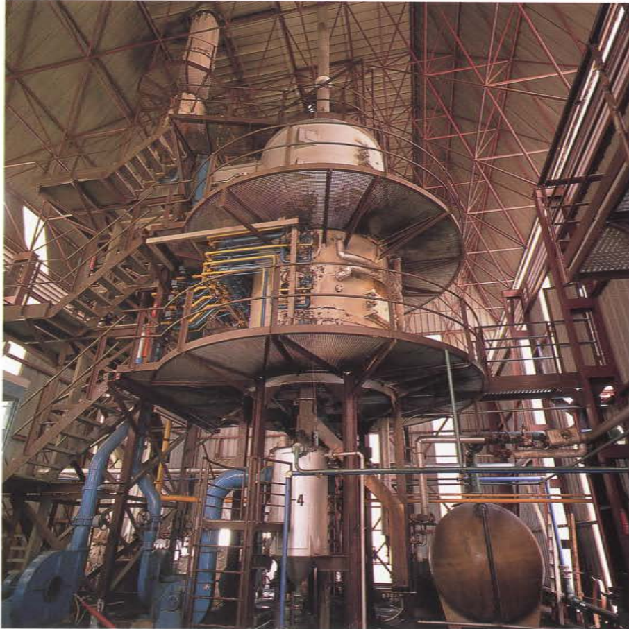
Horno de regeneración de carbón activo
